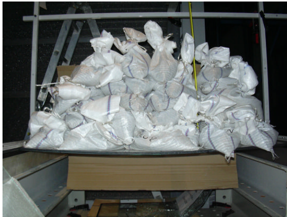
Bild 4: Einachsige gespannte Glastafel, Resttragfähigkeitsversuch, beide Tafeln gebrochen
